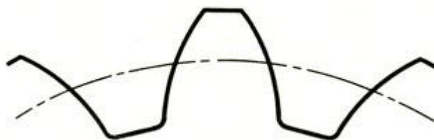
Рис. 51. Эвольвентный профиль зуба
