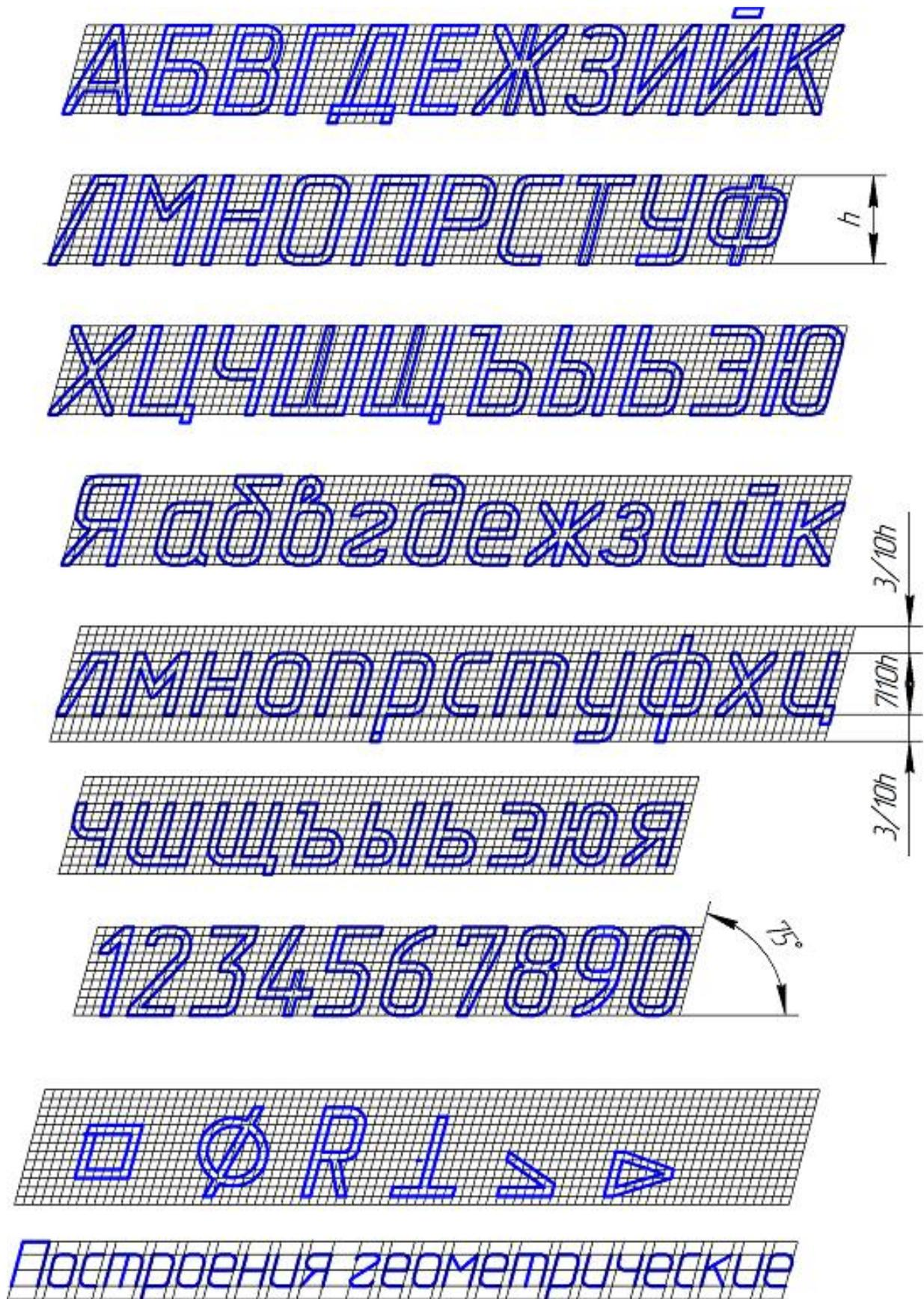
Рисунок 2.3 – Шрифт типа Б с наклоном
