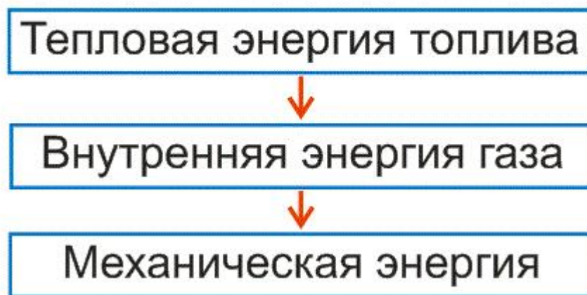
Рис. 3. В тепловом двигателе энергия топлива превращается в механическую энергию
