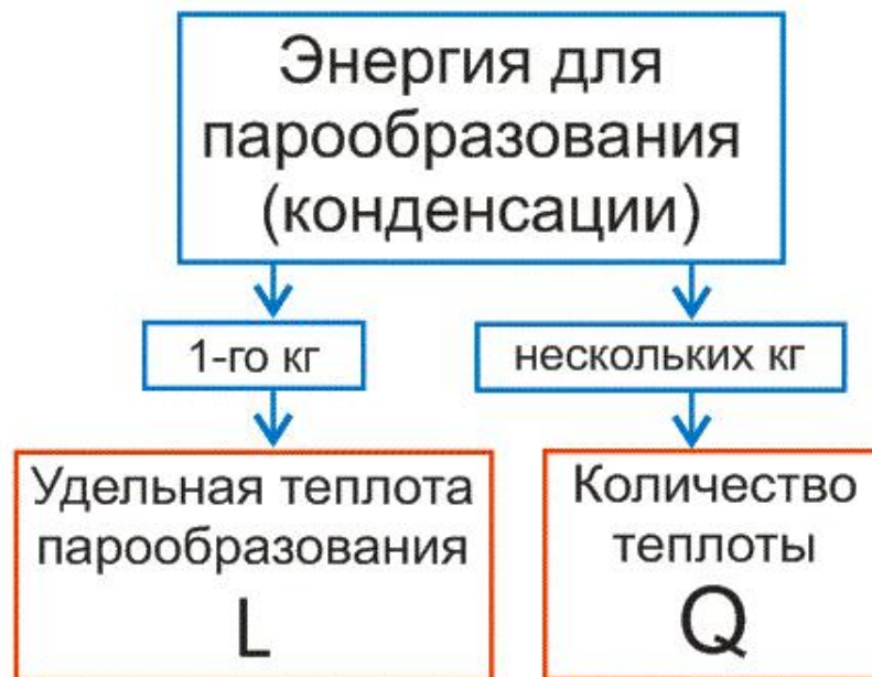
Рис. 8. Если жидкость находится при температуре кипения, то удельная теплота парообразования — это энергия для перевода в пар одного кг жидкости, а количество теплоты — это энергия перевода в пар нескольких кг жидкости
