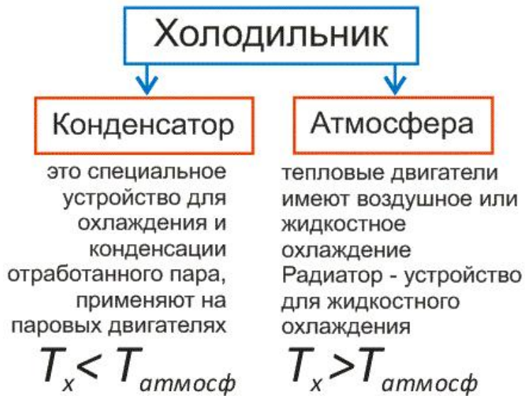
Рис. 3. Если холодильником служит атмосфера, то температура холодильника выше атмосферной, а если – конденсатор, то температура холодильника ниже температуры окружающей среды
