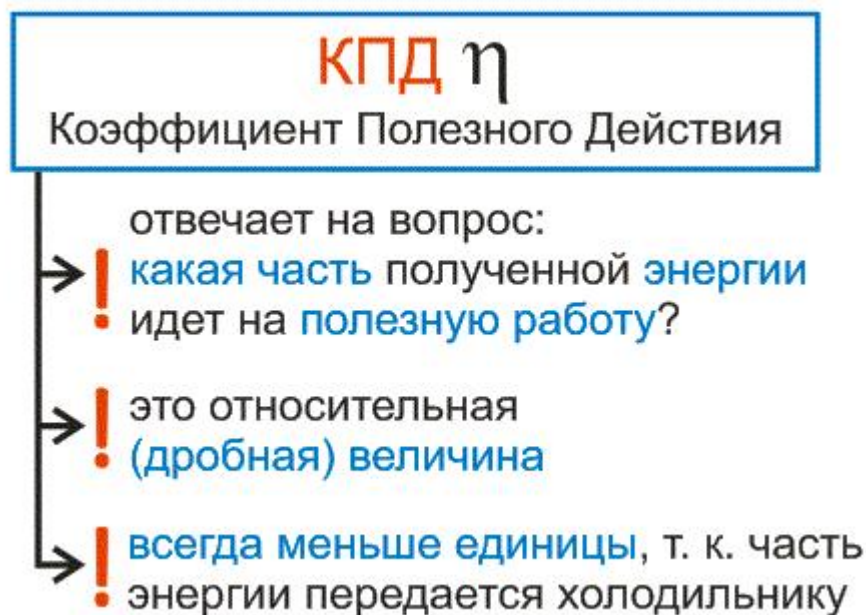
Рис. 5. КПД отвечает на вопрос: какая часть полученной энергии тратится на полезную работу
