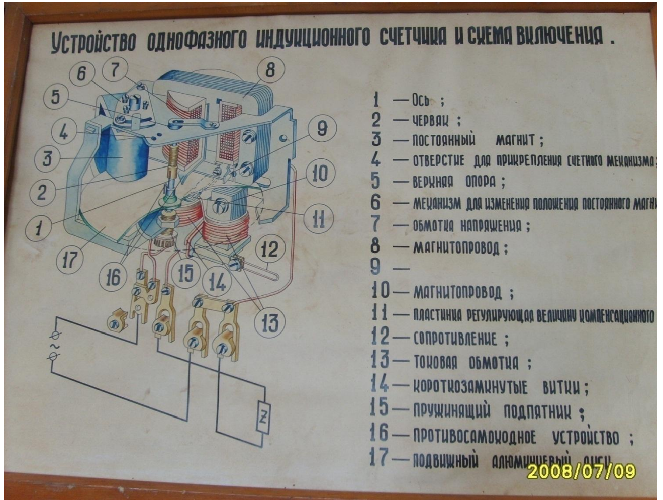
ис. 30 Устройство однофазового индукционного счетчика и схема включения.
