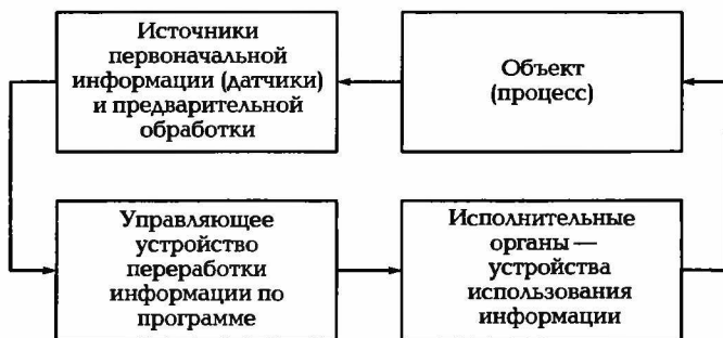
Рис. 1.5. Последовательность передачи информации в системе автоматического управления
