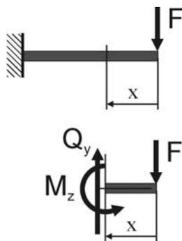
При плоском поперечном изгибе, когда в сечениях балки действуют и изгибающий момент  $M$  и поперечная сила  $Q$ , возникают не только нормальные  $\sigma$ , но и касательные напряжения  $\tau$ .
