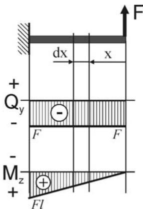
Рассмотрим консольную балку, находящуюся в условиях поперечного изгиба под действием силы  $F$ . Построим эпюры внутренних усилий  $Q_y$  и  $M_z$ .
