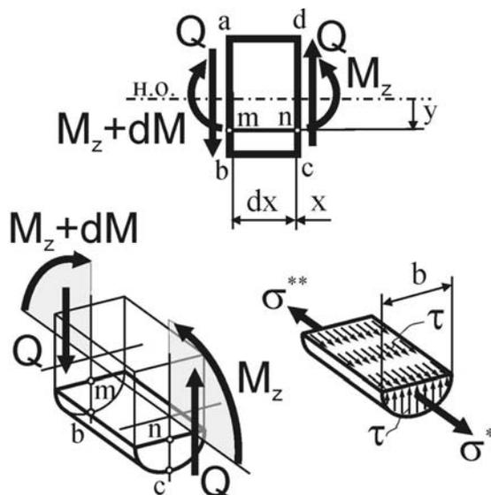
Кроме того, на этих гранях от действия поперечной силы  $Q_y$  возникают касательные напряжения  $\tau$ , такие же напряжения возникают по закону парности касательных напряжений и на верхней грани элемента.
