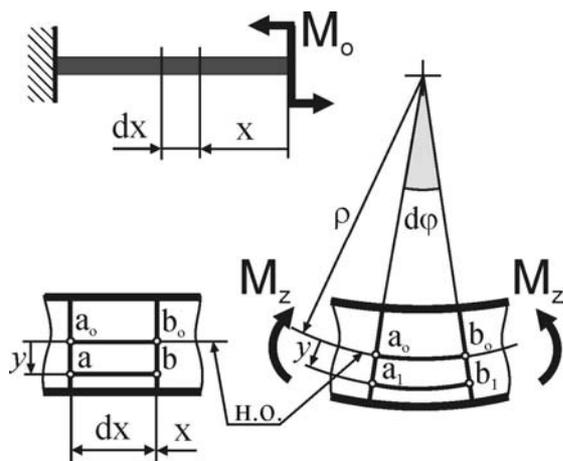
Здесь напомним, что длина волокон, лежащих на нейтральной оси, не изменится, а потому дуга  $a_0b_0$  (радиус кривизны которой обозначим  $\rho$ ) имеет ту же длину, что и отрезок  $a_0b_0 = dx$ .
