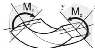
Стержень, работающий на изгиб, называется балкой (или бруском). В дальнейшем будем рассматривать прямолинейные балки, поперечное сечение которых имеет хотя бы одну ось симметрии.
