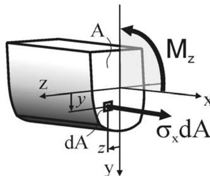
Связь между внутренними усилиями и нормальными напряжениями в сечении балки найдем из рассмотрения напряжений на элементарной площадке  $dA$ , выделенной в поперечном сечении  $A$  балки в точке с координатами  $y$  и  $z$  (ось  $y$  для удобства анализа направлена вниз):
