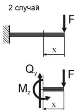
Рассмотрим два характерных случая изгиба: в первом – консольная балка изгибается сосредоточенным моментом  $M_o$ ; во втором – сосредоточенной силой  $F$ .
